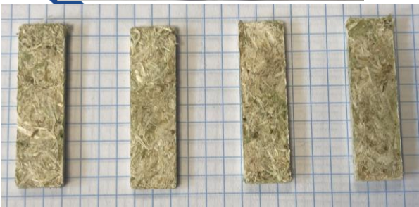
Fibres de talons d'asperge, de tiges de tomate et de concomre pressées
